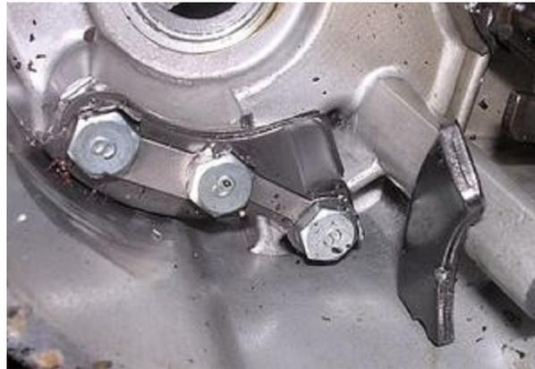
Die Ausrückerei funktioniert aber nur dann optimal, wenn der Kickstarthebel richtig auf der Kickstarterwelle positioniert ist - der Schlitz des Hebels ist dann auf den Körnerpunkt der Welle ausgerichtet. **Das Trittstück des Starters liegt dann parallel zu den Kühlrippen** (siehe Bild)
